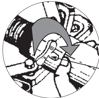
PERILLA DE LA VÁLVULA DE CONTROL
